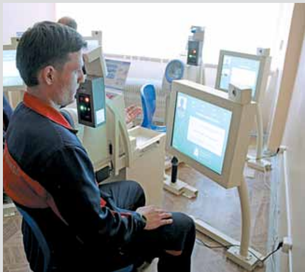
На разрезах «Кузбассразрезуголя» установлены терминалы экспресс-тестирования, на которых горняки проходят проверку перед началом каждой рабочей смены
